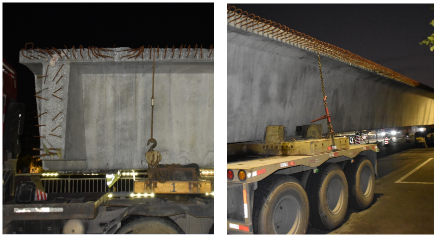
图 1-2 使用铁链在挂车车板对桥梁预制件作两处固定
