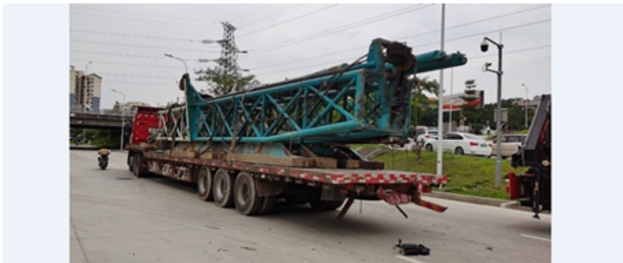
图1 打桩机桩架超出车辆挂车尾部约30cm
