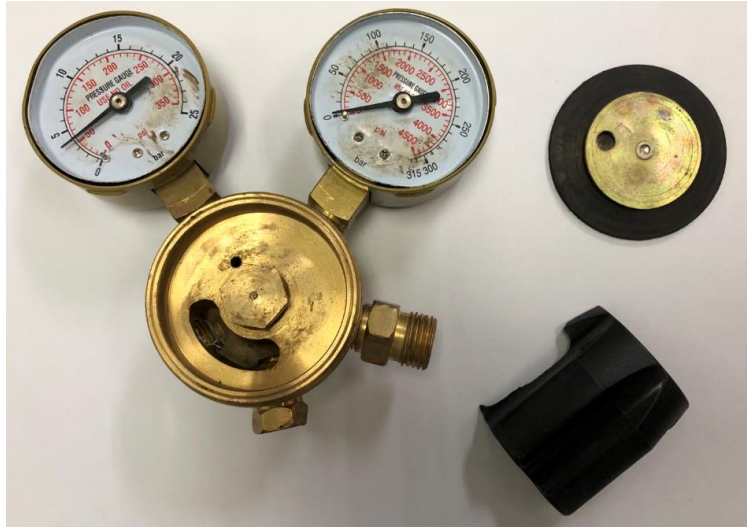
图 4、爆炸冲击损坏的气体减压器
